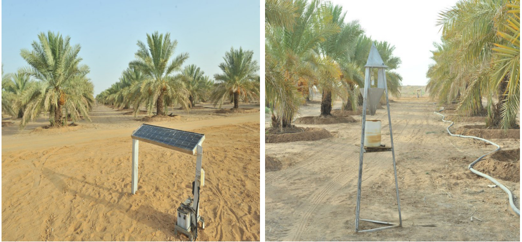
صورة رقم (٢٤) توضح استخدام الخلايا الشمسية لتشغيل المصائد الضوئية لجذب الآفات الحشرية
