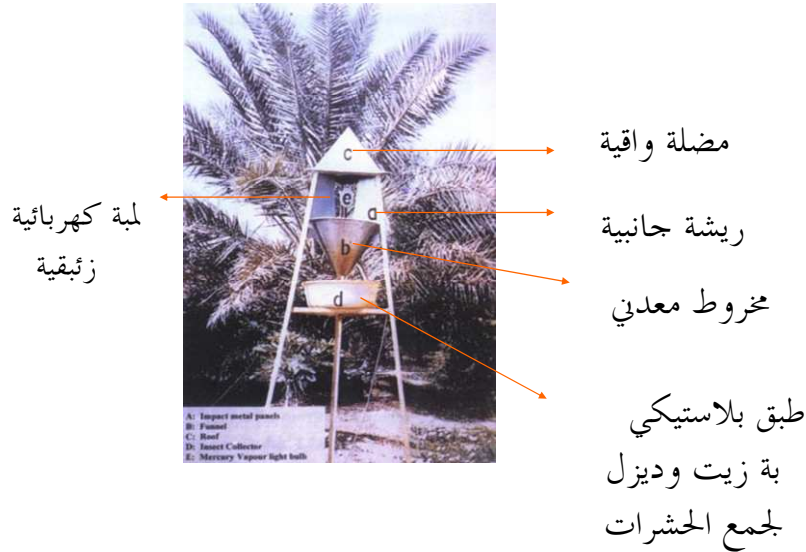
شكل (٦) : المصيدة الضوئية المستخدمة في مكافحة حفارات نخيل التمر
